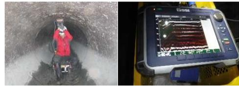
写真-2 電磁波レーダ探査測定状況
